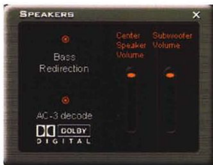
Nella Sounblaster Live! 5.1 la decodifica Dolby Digital può venir effettuata direttamente dalla scheda. In questo caso al mixer tradizionale vengono aggiunti i controlli per il canale centrale e per il subwoofer.
